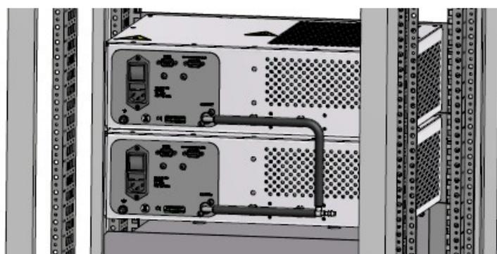
Assécheur à régénération manuelle pour guide d'onde :
